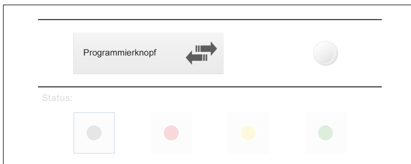
Abb. 16 AP: Programmier Taste in der Smartphone App. Der Aktor verfügt ebenfalls über eine Programmier Taste.
