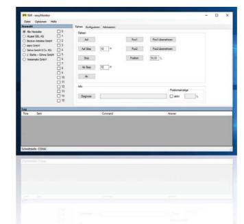
Mit dem "SMI-EasyMonitor" kann die Anlage sehr einfach auf ihre Busfunktion überprüft werden (ohne dabei Kenntnisse des übergeordneten Gebäudesystems zu haben). Hierfür muss der Busstecker auf der KNX-Seite vom Aktor abgezogen werden.
