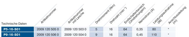
Nennspannung: 230 V/AC / 50Hz Betriebsart: S2 4 min Schutzart: IP44
