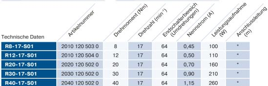
Nennspannung: 230 V/AC/50Hz Betriebsart: S2 4 min Schutzart: IP44
