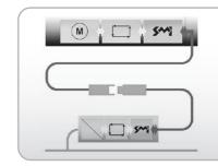
Echte Bi-Direktionalität durch Nutzung der vom Antrieb gelieferten Daten für Statusabfrage, Unterbrechungs-/Leitungsbrucherkennung und Meldung. Eine Visualisierung basiert auf echten Werten. Exakte Positionierung über inkrementale Wegmessung.
