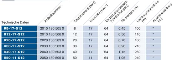
Nennspannung: 230 V/AC/50Hz Betriebsart: S2 4 min Schutzart: IP44
