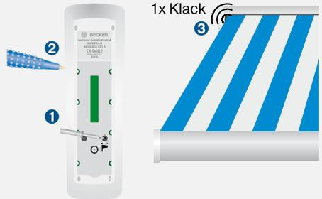
b) Drücken Sie danach die rote Programmier-taste ④ des SC211-II, bis der Rohrantrieb 1x klackt ⑤.
