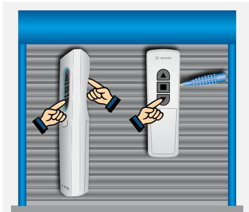
Fahren Sie danach den Behang (Rollladen, Sonnenschutz oder Jalousie) in die obere Endlage. Drücken Sie die Programmier-, und AUF-Taste am CentronicPlus Sender (im Einstellmodus) oder am Centronic Mastersender, bis die Steuerung quittiert.
