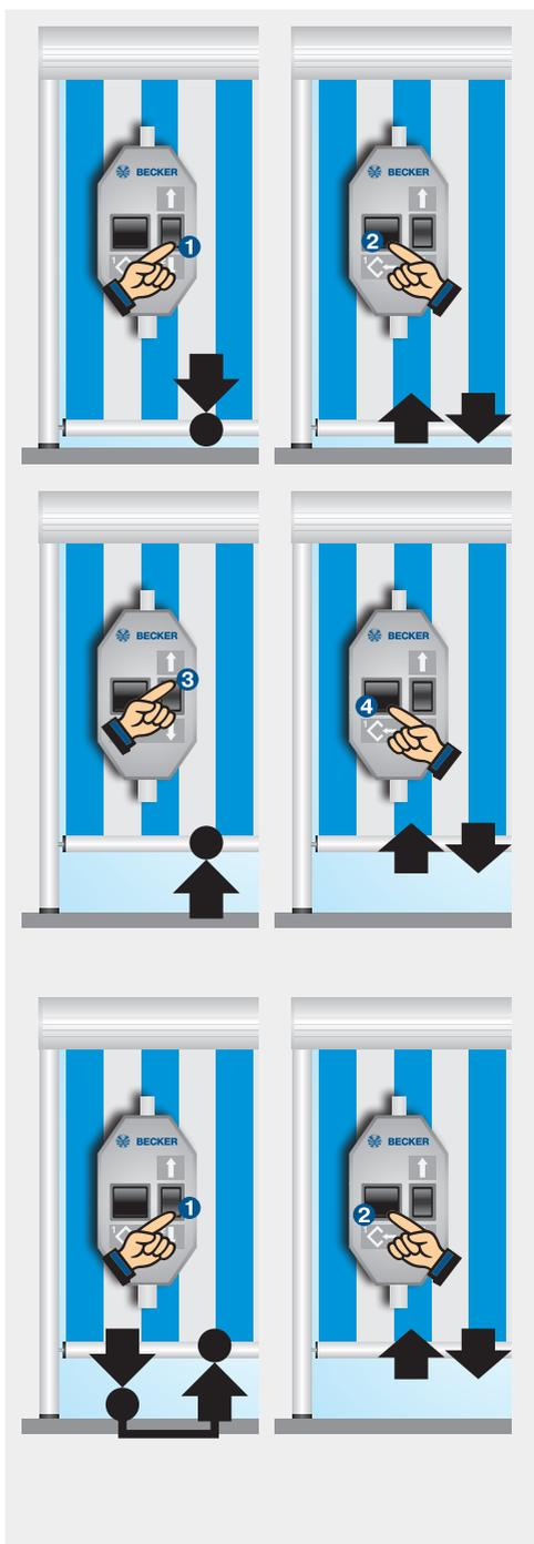
Déplacez ensuite la toile dans la position de tension de la toile ❸ et appuyez à nouveau sur la touche de programmation jusqu'à ce que le moteur confirme par une montée et une descente de la toile ❹.
